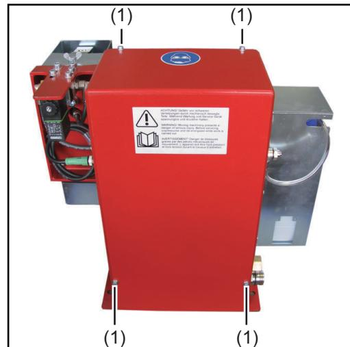
① 使用四个原装螺钉和垫圈(1)将清洁设备外壳盖拧紧
